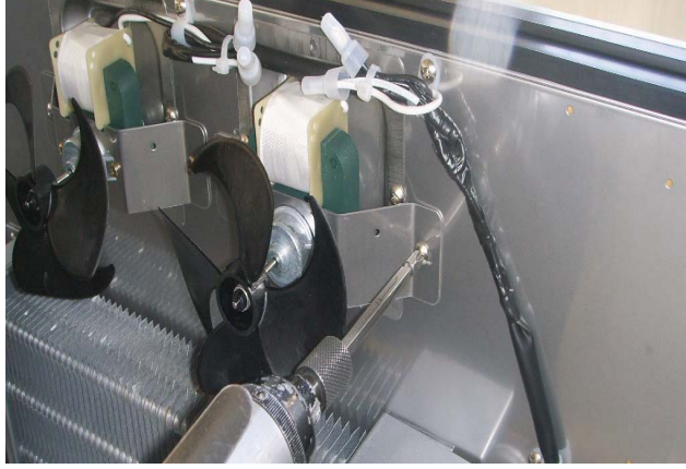
B.Remove the evaporator fan motor
